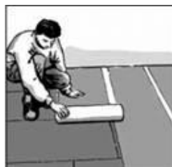
Г На поверхность пола наносим армирующую полосу.
